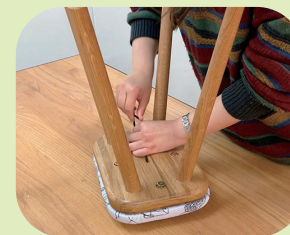
5. 座面と本体をボルトで留める
